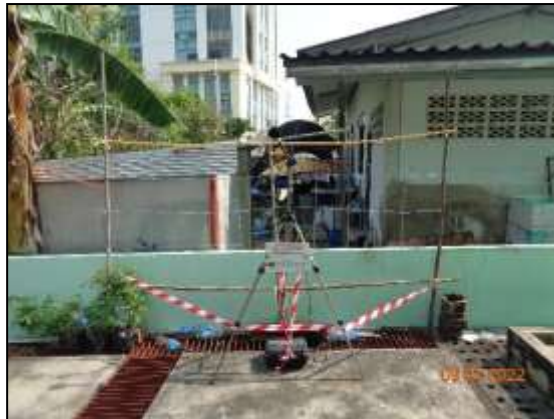
รูปที่ 3-7 การตรวจวัดระดับเสียงรบกวน บริเวณ รพ.สต.ดอนหัวฬ่อ
